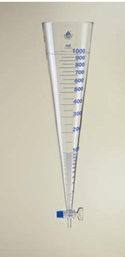
nach Imhoff, DIN 12672, auf Einguss justiert (In), **Graduierung bis 1000 ml**, Borosilikatglas 3.3
