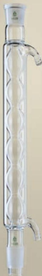
**Kugelkühler nach Allihn** mit Kegelschliffhülse und -kern, DIN 12581, Borosilikatglas 3.3
