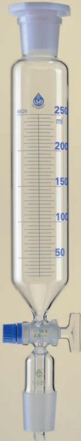
zylindrische Form, DIN ISO 4800, mit Kegelschliffhüse und Kegelschliffkern, **massives Glasküken, graduiert**, PE-Stopfen, Borosilikatglas 3.3
