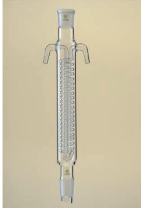
**Schlängenkühler** mit Kegelschliffhülse und -kern, Borosilikatglas 3.3
