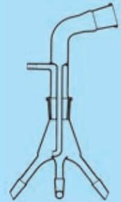
**Vakuumvorstoß** mit Kegelschliffhülse und -kern gleicher Größe, DIN 12594, Borosilikatglas 3.3
